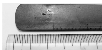
図-4-4 曲尺 裏目拡大 〇ノ〇（大野）銘 大野規周刻印
