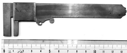
図-2-1 ①挟尺 最小分解能2厘
